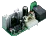
CARICA zásuvná karta pro automatické dobíjení akumulátorů
