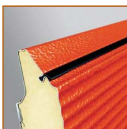
Panel o síle 45 mm ( U=0,8 \text{ W/m}^2\text{K} )
